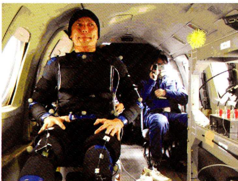
航空機による無重力実験 急上昇急降下で20秒間の無重力が得られる。 これを1時間に最大15回、10日間の実験期間で 4回のフライトを行った。
